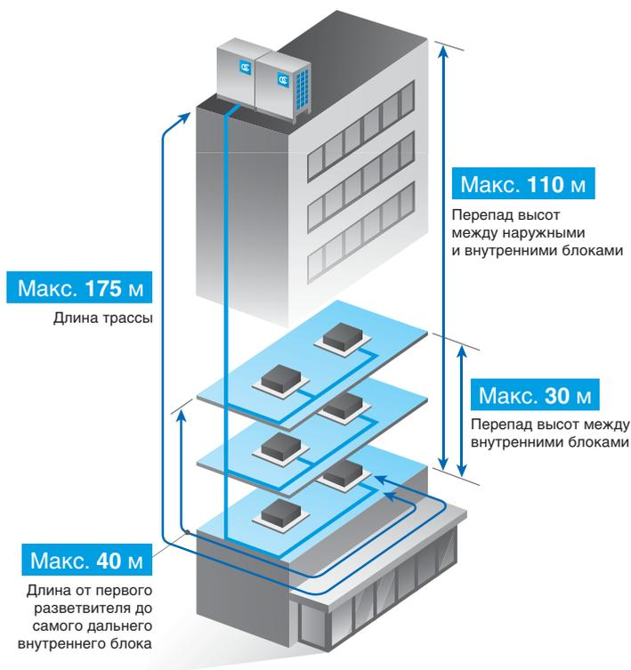
Один из ключевых вопросов при проектировании систем кондиционирования зданий — нахождение оптимального места размещения наружных блоков. Для этого необходимо учесть требования к длине труб, соединяющих наружные блоки с внутренними, занимаемую площадь и рабочий вес оборудования, возможность доступа к наружным блокам для сервисного обслуживания.
