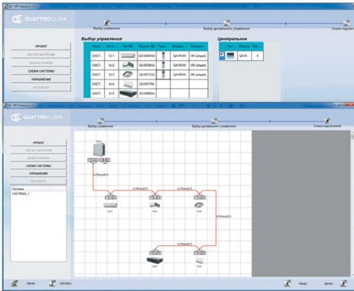
После нажатия кнопки «РАССЧИТАТЬ» программа произведет расчет системы и проверит возможность ее функционирования. Чтобы посмотреть результаты системы, нажмите кнопку «ПОДРОБНО».
