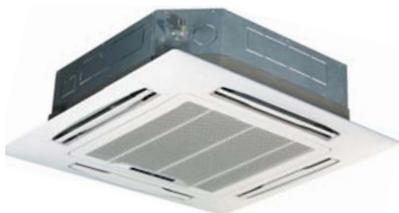
В кассетных внутренних блоках распределение потока воздуха происходит одновременно по четырем направлениям, что позволяет равномерно распределять обработанный воздух в помещениях большой площади и достигать комфортной температуры в каждой части помещения. Для равномерного распределения потока воздуха кондиционеры такого типа устанавливаются в центре помещения. Основная часть внутреннего блока монтируется за подвесным потолком и закрывается декоративной вентиляционной панелью.
