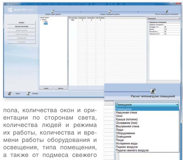
пола, количества окон и ориентации по сторонам света, количества людей и режима их работы, количества и времени работы оборудования и освещения, типа помещения, а также от подмеса свежего воздуха.
